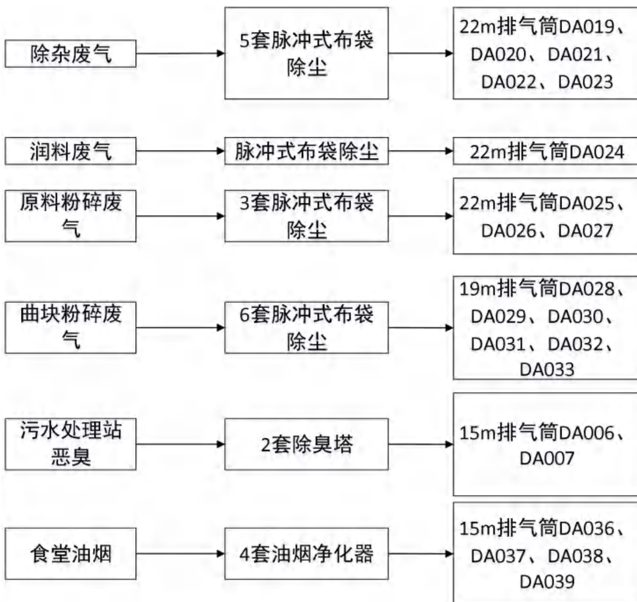
图 4-2 有组织废气产生与治理工艺流程图
